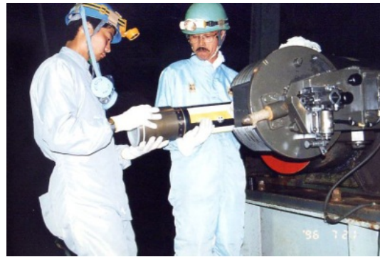
図 20. 高圧ガスによる衝撃試験装置
