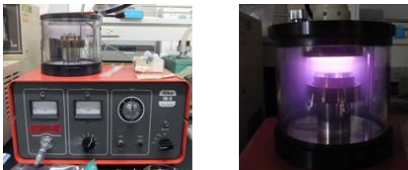
図 5 EIKO 製イオンコーター（左）とコーティング（放電）中の状態（右）
