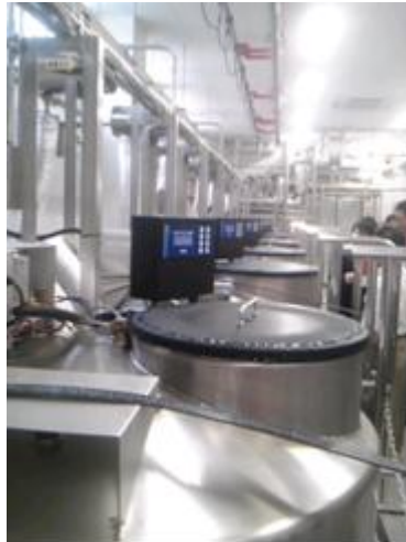
図 10 IBBP センターの液体窒素凍結保存システム
