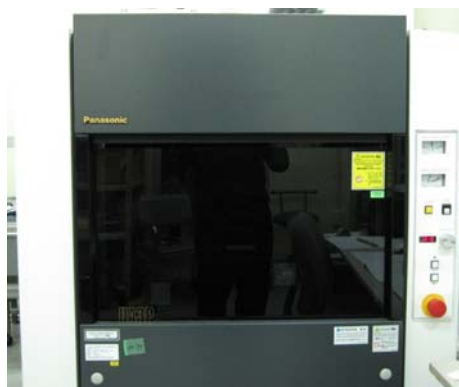
図 8 超高精度三次元測定機 UA3P
