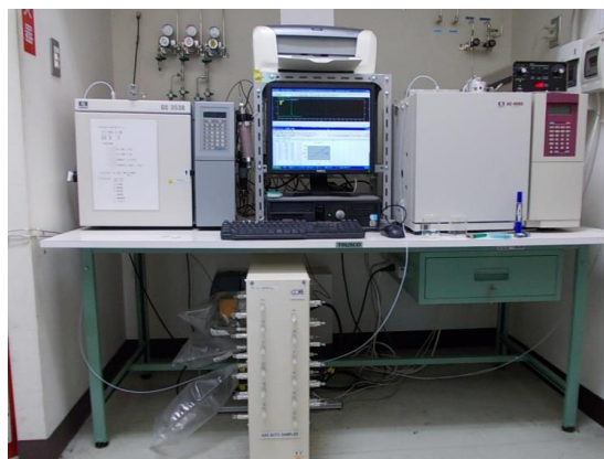
画像1. サンプルバック（上からテドラー、PA、2F） 画像2. ガスクロマトグラフ（左側 GC/FID、右側 GC/ECD）
