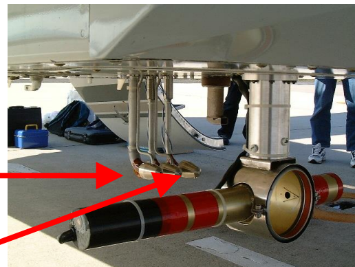
図 18 空気採集器先端部概要および航空機に設置した空気採集器 (右側はレーザーを使用した粒径測定装置)
