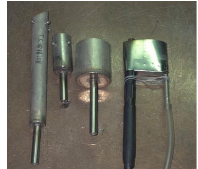
図 11 チタン TIG 溶接用治具 (裏側などの酸化防止用)
