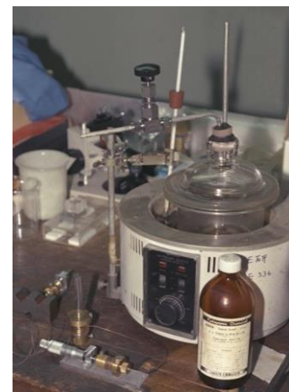
図 20 駆動液挿入用真空デシケータ (減圧により配管内に空気の混入が無い駆動液のみを挿入)
