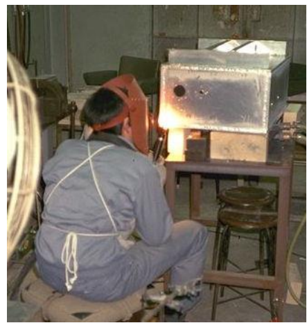
図4 遠赤外顕微分光装置容器のアルミ溶接作業
