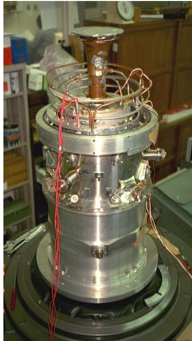
図 8 ロケット搭載赤外線観測装置 (振動試験機による GFRP の強度実験)
