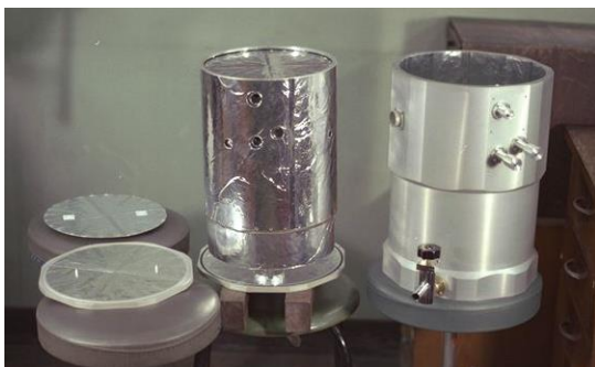
図5 製作したクライオスタット (右から真空断熱容器、液体ヘリウムタンクおよび液体窒素タンク、ふた)
