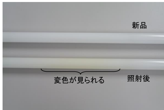
図 7. LED 照明管の照射の影響
