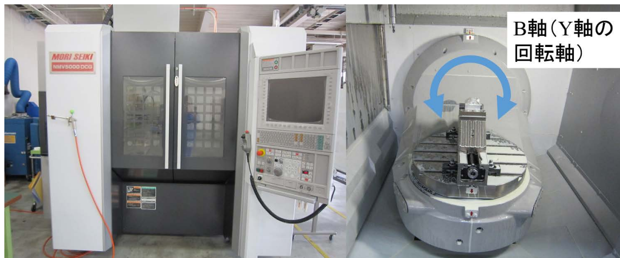
図 2. 使用 5 軸制御マシニングセンタ（森精機 NMV5000 DCG）
