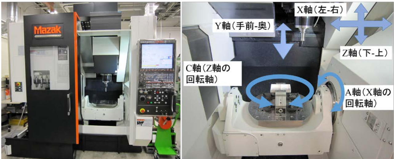
図 1. 本装置開発室の 5 軸制御マシニングセンタ(Mazak VARIAXIS j-500/5X)
